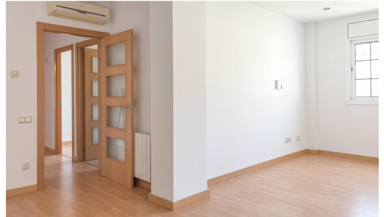
Los solados de las viviendas son laminado sintético color madera natural, así como la carpintería interior. La carpintería exterior es de aluminio lacado en blanco con rotura de puente térmico y doble cristal tipo climalit. Las persianas son de aluminio accionadas con cinta en todas las estancias, excepto en el salón comedor donde están motorizadas.
